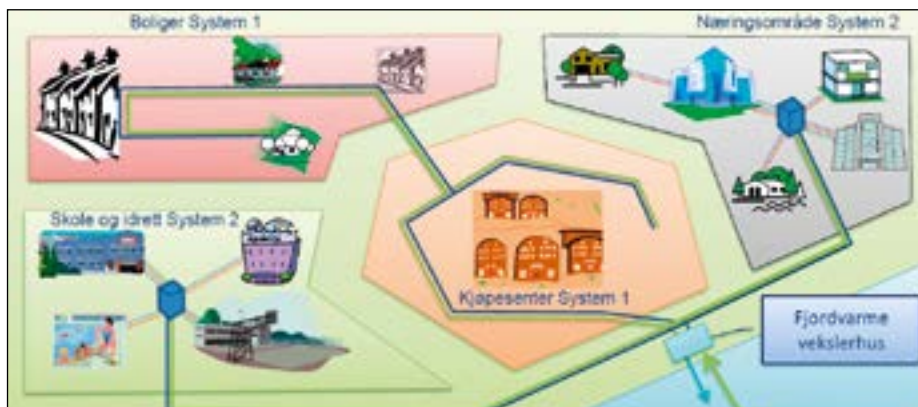
Temperaturen på 8-12 oC gir gunstige høve for oppvarming ved hjelp av varmepumper og direkte kjøling av ventilasjonsluft. I tillegg kan fjordvarmerøra nyttast til å bli kvitt overskotsvarme.
